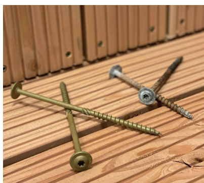
VERSCHIL TUSSEN AR-COATING EN VERZINKT NA 6 MAANDEN IN DOUGLAS HOUT
